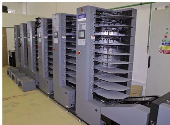
Snášení se provádí na stroji Duplo
