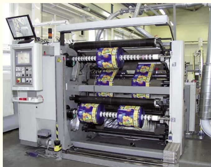
Ve výrobním provozu společnosti Chemosvit Folie, předního slovenského výrobce flexibilních obalových materiálů, bylo instalováno již druhé zařízení Venus II na podélné ořezávání, prořezávání a převíjení kotoučových materiálů z produkce lanškrounské společnosti SOMA Engineering
