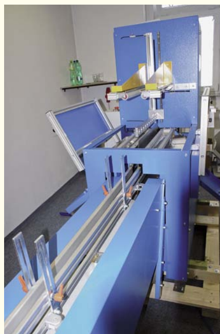
Základní model zavěšovacího stroje X-case z produkce společnosti Zechini je určen pro výrobu malých a středních nákladů tuhých vazeb V8
